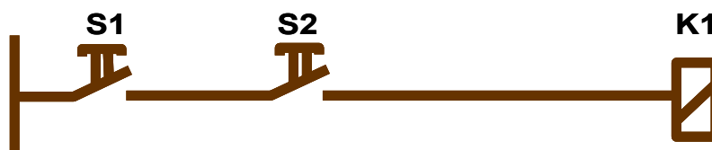
Schemat elektryczny odpowiadający funkcji AND
